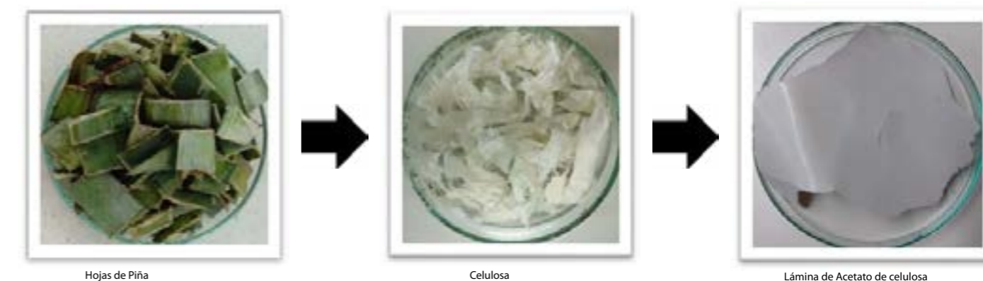
Figura 1. Secuencia de obtención de acetato de celulosa a partir de hojas de piña.
