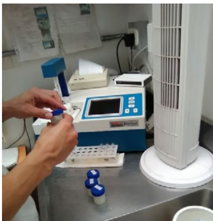
Figura 3. Medición punto crioscópico Fuente: Registro SENA
