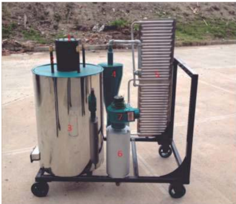
Figura 3. Prototipo Sistema Reactor de gasificación en corriente descendente (SENA- CTCM BOGOTÁ).
