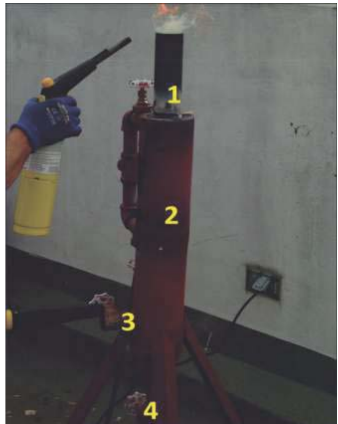
Figura 8. Prototipo Sistema Reactor de gasificación en corriente ascendente (SENA- CTCM BOGOTÁ)
