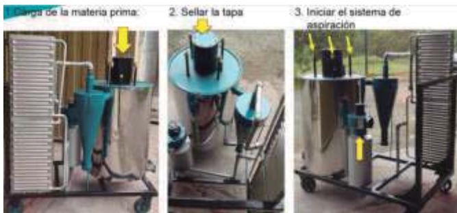
Figura 5. Pasos iniciales para operar el sistema de gasificación
