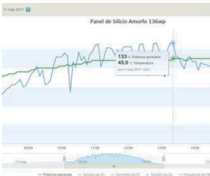
Figura 7. Curva de potencia - temperatura de panel Silicio Amorfo con datos medidos del sistema de monitoreo
