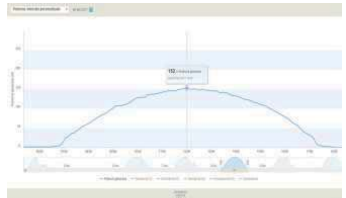
Figura 9. Curva de potencia panel monocristalino de 160wp (Bogotá)
