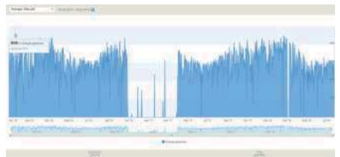
Figura 10. Curva de historial de generación de energía panel monocristalino de 160wp (Guajira)
