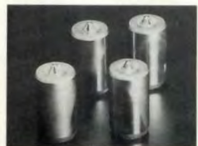
Fig. 9 Punzones de conformado para la fabricación de tornillos con cabeza Philips
