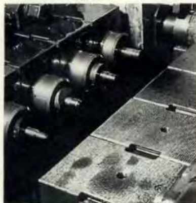
Fig. 1 Herramientas de conformado en frío recubiertas para la producción de casquillos dentados
