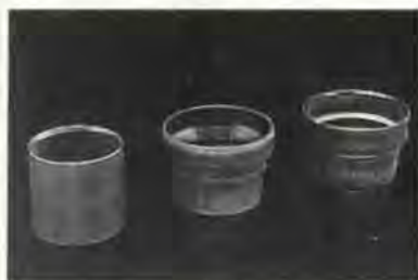
Fig. 10 Tres pasos del conformado de un tubo para un quemador de petróleo
