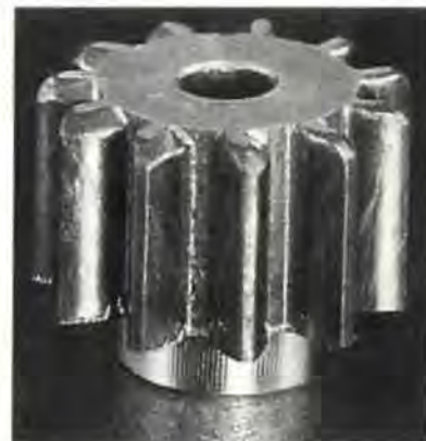
Fig. 5 Engranaje fabricado en proceso de conformado en frío
