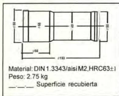
Fig.2 Los costes de producción y vida de la herramienta de la tabla1 corresponden a este punzón de conformado
