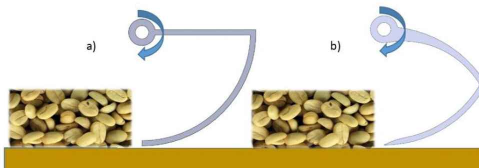
Figura 5. a) Uña máximo volumen y b) uña optimizada entre volumen homogeneidad.
