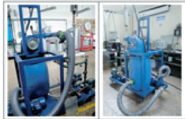
Figura 15. Banco de pruebas de microgeneración hidroeléctrica. Laboratorio Plantas Térmicas y energías renovables. Universidad Nacional de Colombia. Sede Bogotá
