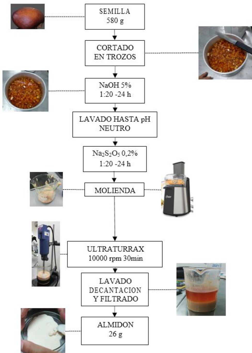
Figura 1. Esquema descripción del procedimiento utilizado para la extracción de almidón a partir de semillas de aguacate. Fuente: elaboración propia.
