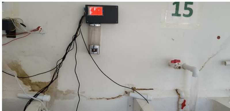
Figura 13. Sistema de monitoreo implementado en tanque de alevinos Fuente: elaboración propia.
