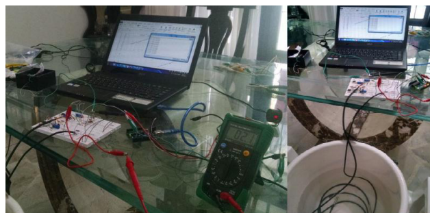
Figura 11. Pruebas para calibrar PT100 Fuente: los autores.
