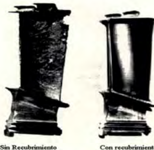
FIG. 2. RESULTADO DE 2500 H DE VUELO A BAJA ALTITUD SOBRE EL MAR, EN UN ÁLABE DE TURBINA CON Y SIN RECUBRIMIENTO DE \text{NiAl} (SOURMAIL, 2002).
