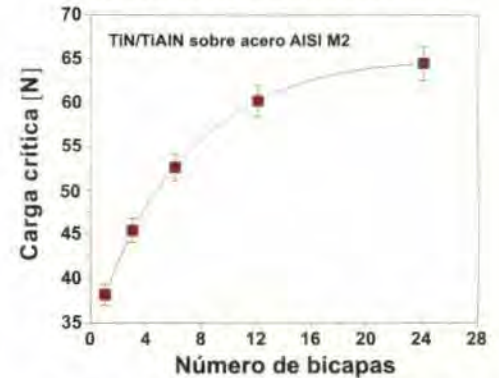
Figura 5. Adherencia del TiN/TiAlN depositado sobre probetas de acero AISI M2 en función del número de bicapas determinada por el método de rayado (Scratch Test).
