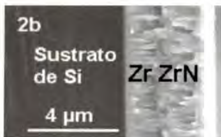
b) morfología de la microestructura tipo columnar del ZrN
