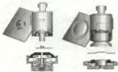
Figura 8. Ejemplos de conformado en punzonadora CN de Mate Punch & Die Co
