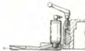
Figura 16. Garras de sujeción de la chapa
