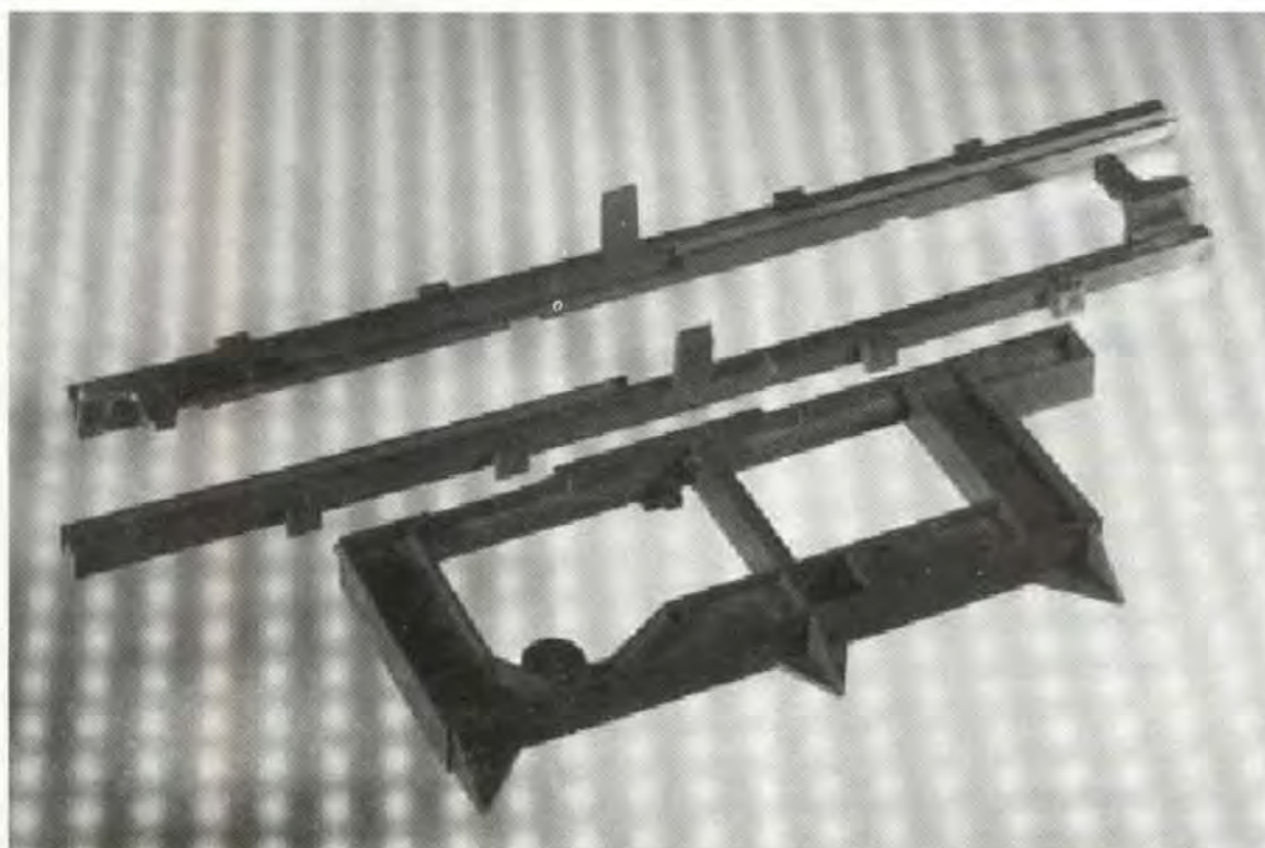
Figura 1. Las partes de computadora hechas de una mezcla PC/ABS (grado Bayblend RFR 390) de color oscuro son producidas utilizando un reciclado base de CD.
