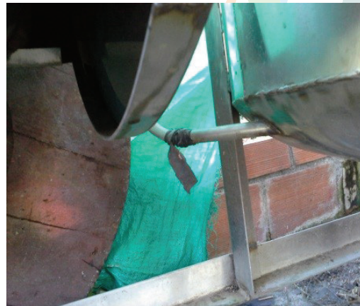
Imagen 15. Tubo conductor de vapor con necesidades de mantenimiento y automatización - Driver steam pipe with maintenance and automation needs
