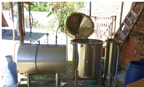
Imagen 6. Planta de destilación extractora de aceites esenciales ubicada en el municipio del Socorro, Santander - Extraction plant for distillation of essential oils located in the municipality of Socorro, Santander (Uribe, 2014).
