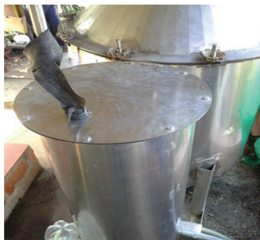
Imagen 9. Condensador con problemas de fuga de agua - Condenser with water leakage problems
