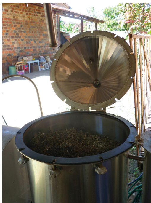
Imagen 3. Tanque extractor de la planta ubicada en el municipio del Socorro, Santander - Extraction tank of the plant located in the municipality of Socorro, Santander (Uribe, 2014).
