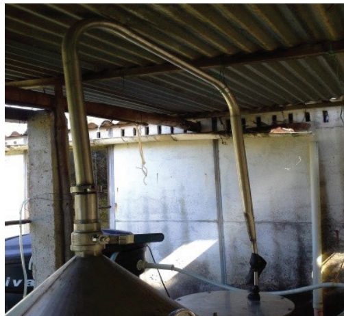
Imagen 15. Tubo conductor de vapor con necesidades de mantenimiento y automatización - Driver steam pipe with maintenance and automation needs
