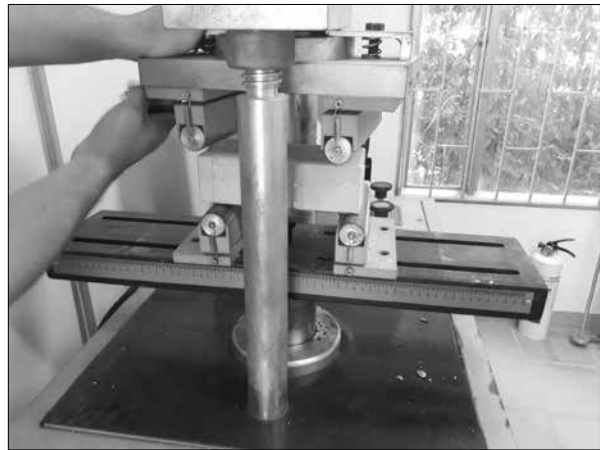
Foto 1: Ensayo de flexión en laboratorio. Fuente: elaboración propia.
