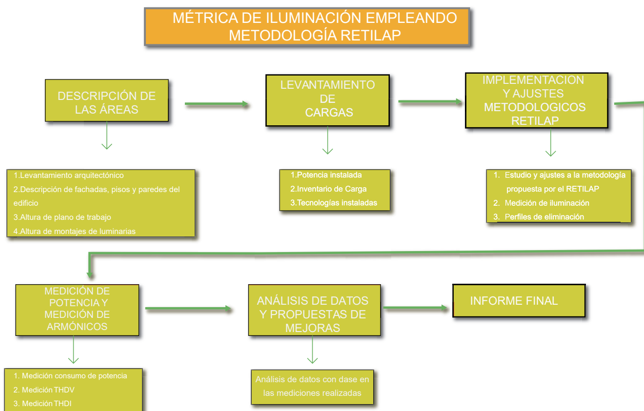
Imagen 2. Métricas de iluminación empleando metodología RETILAP
