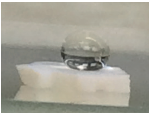
Figura 2. Imagen de la medición de ángulo de contacto de las nanopartículas de \text{SiO}_2
