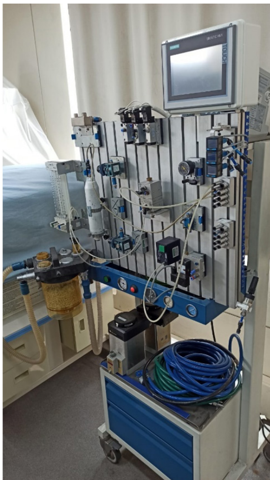
Figura 4. Máquina de anestesia didáctica con PLC y válvulas de entrada de gases
