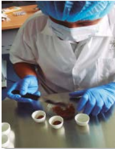
Fotografía 3. Preparación de muestras de polen para Análisis Termogravimétrico.
