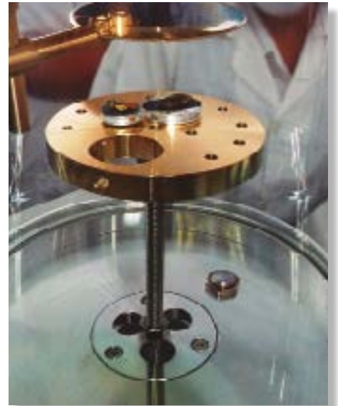
Fotografía 4. Muestras de cúmulos polínicos en el recubridor de materia orgánica, listas para ser recubiertas con oro.
