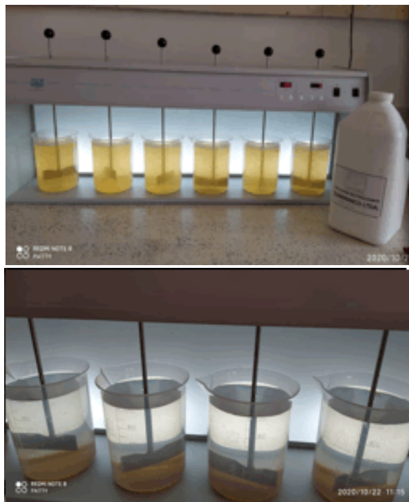
Imagen 2. Montaje realizado para prueba de jarras.
