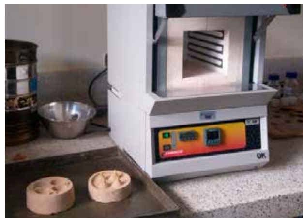
Figura 3. Cocción de prototipos a escala en mufla, Fuente: Autores
