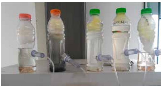
Foto 3. Prototipo a escala laboratorio y evolución del crecimiento de las BSR en agua de la mina
