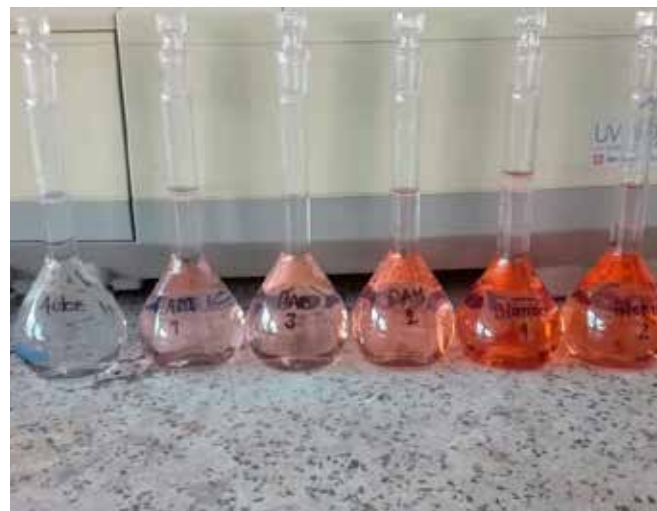
Foto 2. Medición de hierro por método espectrofotométrico
