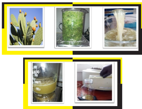
Figura 1. Proceso de extracción del mucilago de nopal por técnica de cocción y solventes
