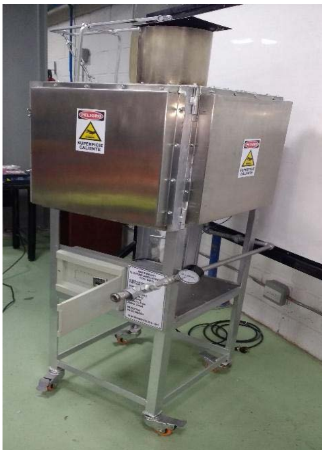
Figura 3. Fotografía del Horno mufla construido. (Fuente: SENA)
