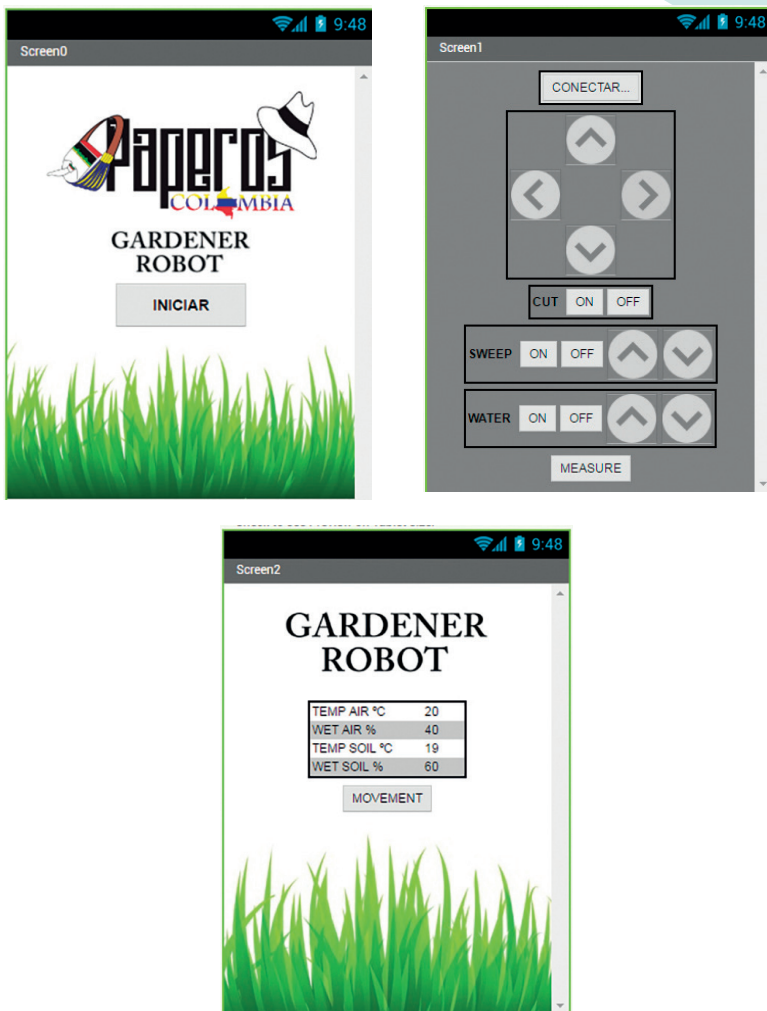
Figura 2. App, control de robot y visualización de variables
