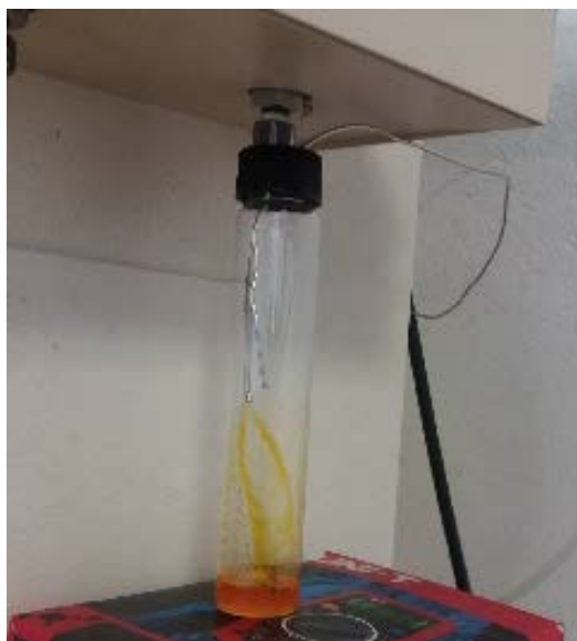
Figura 3. Extracto con carotenoides extraídos por FSC de muestras de zanahoria.
