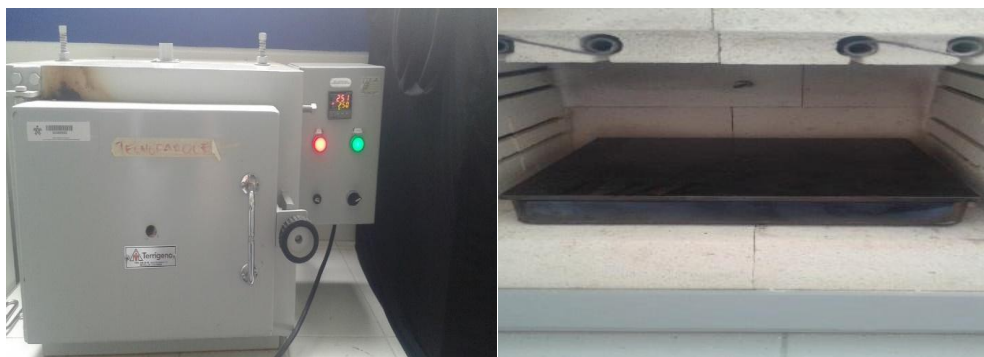
Figura 6. Mufla donde se realizaron los diferentes experimentos para la fundición de materia la prima
