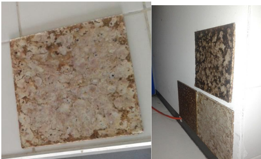
Figura 7. Recubrimiento no cerámico obtenido 100% de plástico y su implementación.
