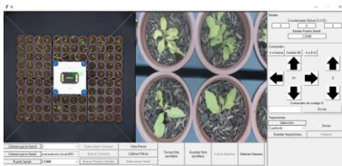
Figura 4: Interfaz gráfica para el control y monitoreo del robot AgroCablebot para la automatización de procesos de siembra, riego e inspección de plántulas en cultivos a pequeña escala.
