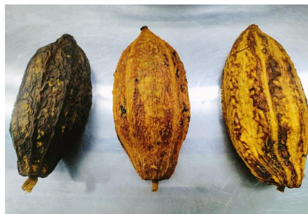
Figura 04. Evaluación de tres métodos de fijación de color. De izquierda a derecha, ácido cítrico, flameado, escaldado.
