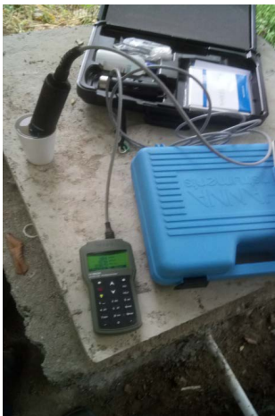
Figura 2. Monitoreo in situ de parámetros fisicoquímicos en las aguas grises antes y después de filtro.
