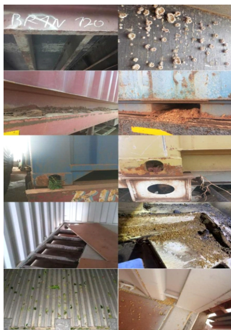
Figura 2. Contaminación fitosanitaria al exterior e interior del contenedor marítimo. Fuente: recopilación del autor
