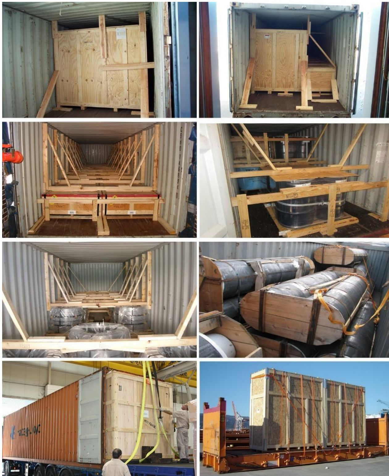
Figura 4. Material de Estiba de Madera (MEM) empleado en la manipulación, fijación, sujeción y trincaje de cargas contenedorizadas.
