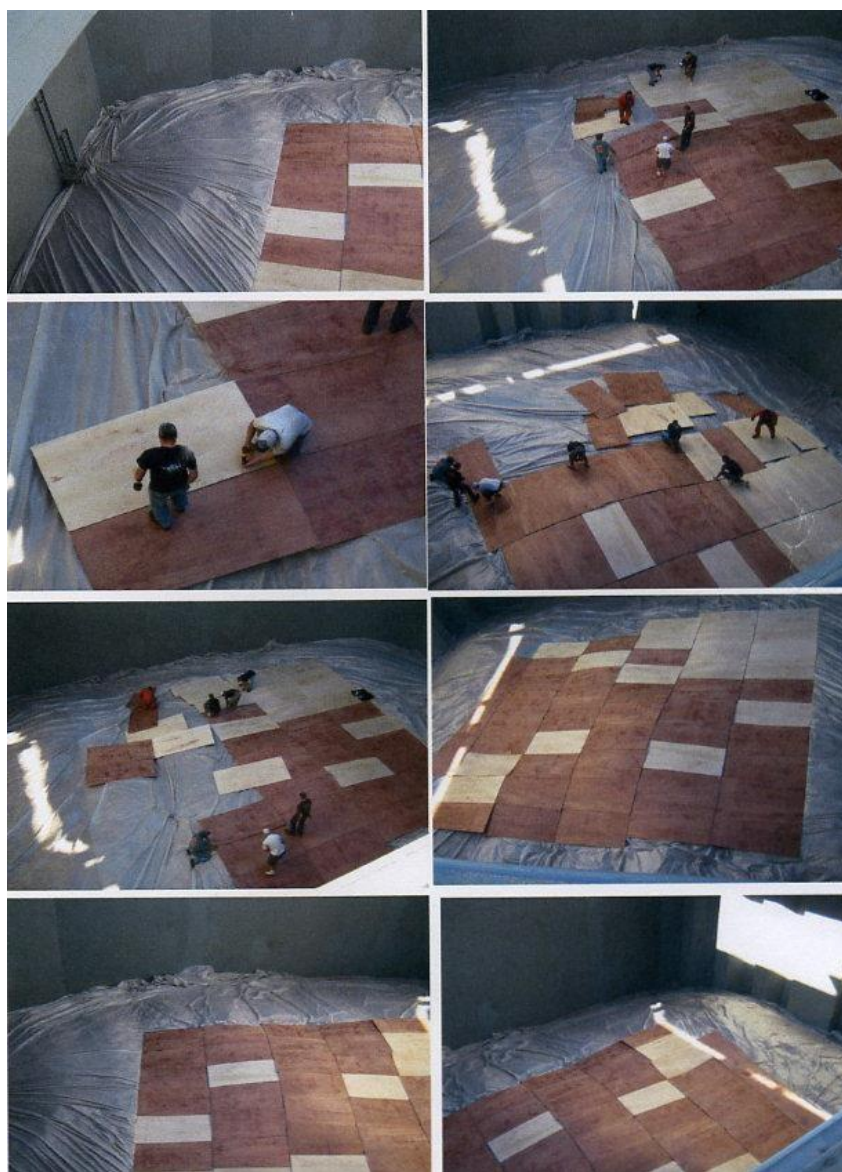
Figura 3. Material de Estiba de Madera (MEM) empleado en la división de cargas (trimado) en las bodegas de los buques mercantes.
