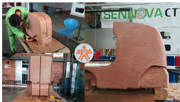
Figura 4: proceso de modelado análogo con Clay del
