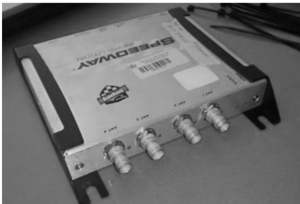
Figura 3. Transpondedor o lector. Fuente: semillero de investigación.
