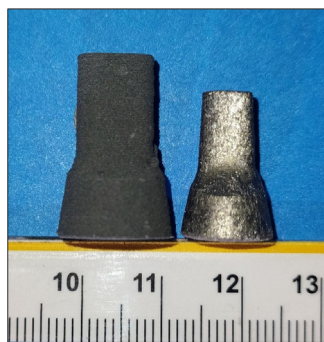
Figura 7. Prototipo de punzón para trabajo en caliente, izquierda prototipo impreso mediante MABE, derecha prototipo sinterizado 100% metal.
