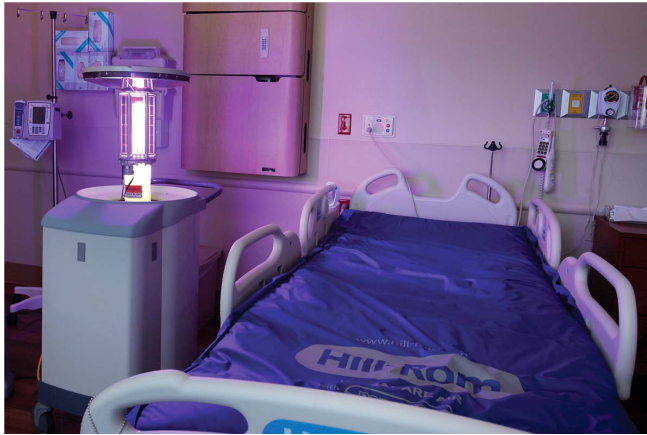
Figura 2. El sistema de desinfección con luz ultravioleta (UV) pulsada de xenón utiliza luz UV de alta energía para dañar las paredes celulares de bacterias, virus y esporas bacterianas. Nota: Fuente: (Knudson, 2013)
