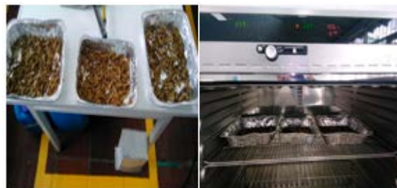
Figura 8. Secado de la materia prima. Nota: Preparación de muestra para el secado (izq.) Muestra ubicada en el horno de secado convectivo a 95 °C durante 5 horas (der.).
