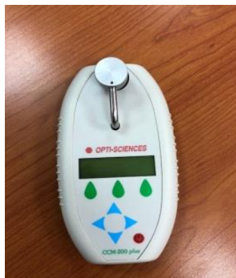
Figura 5. Clorofilometro Opti-Sciences® CCM-200 plus del CBC
