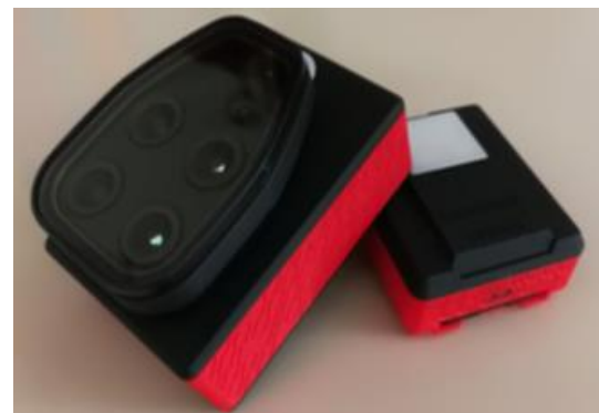
Figura 3. Cámara parrot sequioa, utilizada para la toma de imágenes multiespectrales en cultivo.
