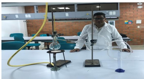
Figura 8. Montaje habitual de la destilación simple
