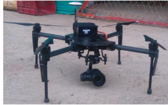
Figura 2. Drone matrice 100, utilizado para vuelo de toma de imágenes.
