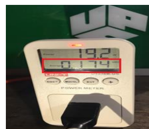
Figura 13. Consumo total en medidor multifuncional de potencia UT230B.
