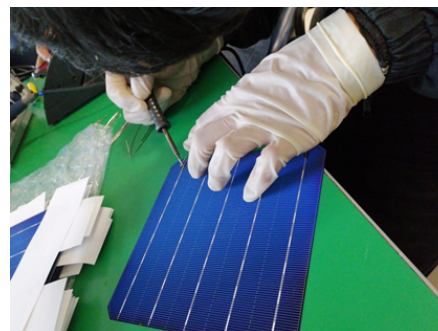
Figura 3. Proceso de soldadura para interconectar las celdas en serie
