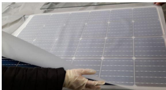
Figura 6. Ensamble del panel (colocación de la segunda capa de EVA)
