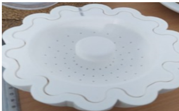
Figura 8, 9, 10 y 11. Moldes elaborados por medio de Manufactura Asistida por Computadora CAM y FDM. Fuente autor.
