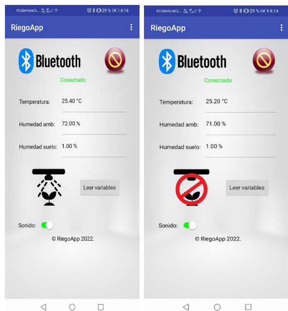
Figura 5. Interfaz de RiegoApp. a) Opción para encender el riego. b) Opción para apagar el riego.
