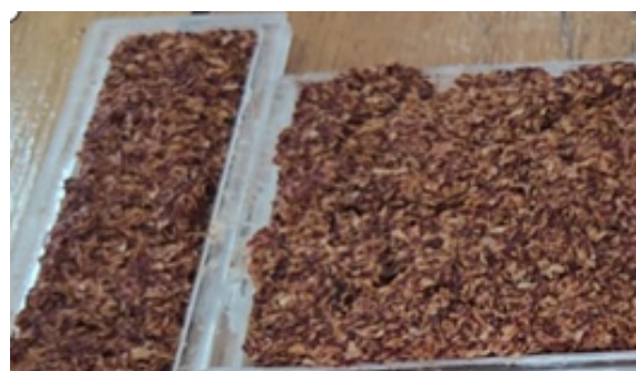
Figura 1. Biomaterial a base de pergamino de café y Mesocarpio y Epicarpio de Cacao. Fuente autor.
