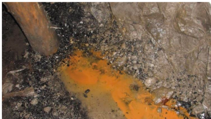
FIGURA 1: PRODUCTO DE LA OXIDACIÓN DE SULFUROS EN MINERÍA DE CARBÓN (MINA LA MARGARITA TITIRIBÍ- ANTIOQUIA). SALAZAR (2014)
