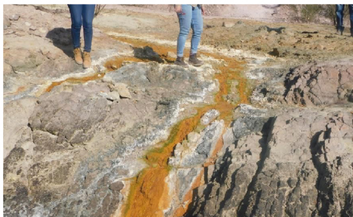
FIGURA 2: FORMACIÓN DE SULFATOS, ALREDEDOR DEL DRENAJE ACIDO (MINERALIZACIÓN BLANCA), GENERADO EN UN RELAVE EN LA MINA NACÓZARI EN MÉXICO. SALAZAR (2018)
