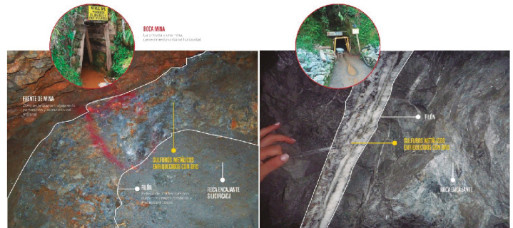
Figura 4. Diagrama frente de mina unidad geometalúrgica 2.
