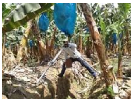
Figura 1. Nivelación de los pozos de la red freatimétrica 2013
