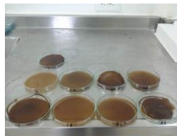
Primeras muestras de bioplástico obtenidas a partir de almidón de banano
