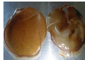
Primeras muestras de bioplástico obtenidas a partir de almidón de banano
