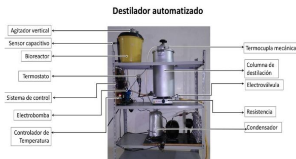
Figura 1. Destilador automatizado construido en laboratorio.
