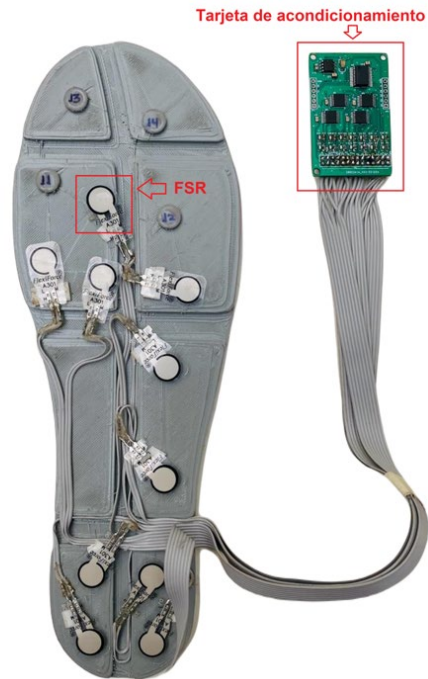
Figura 11. Conexión de sensores.
