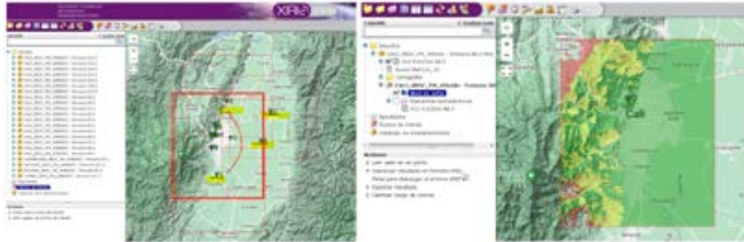
Figura 2. 2(a) Simulación estándar IBOC en Cali. 2(b) Simulación de una emisora empleando IBOC Híbrido en la banda de FM.
