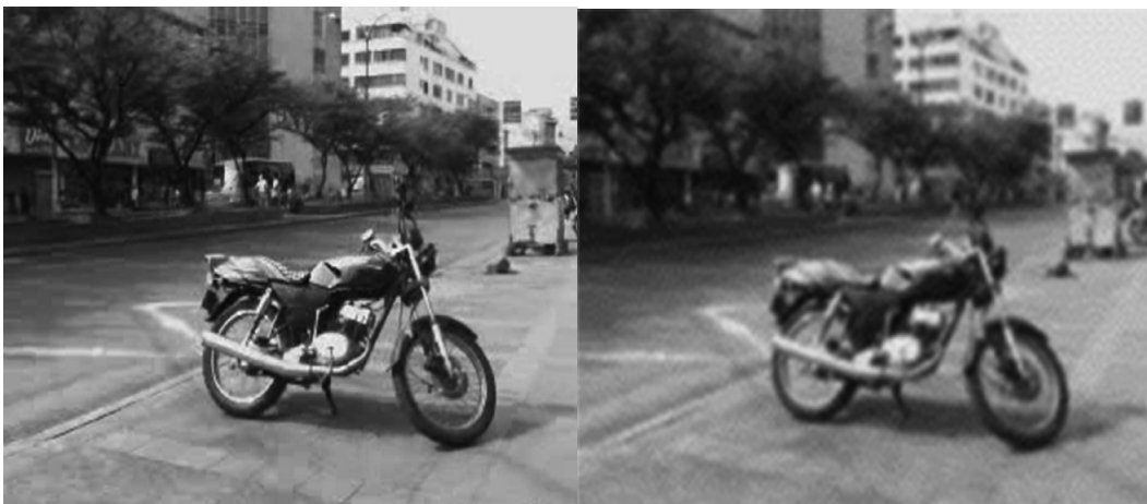
Figura 10. Matriz aplicada. A la izquierda la imagen original capturada por una de las cámaras del sistema estéreo. A la derecha la imagen después de ser convertida a escala de grises y aplicar la matriz tipo GaussianBlur
