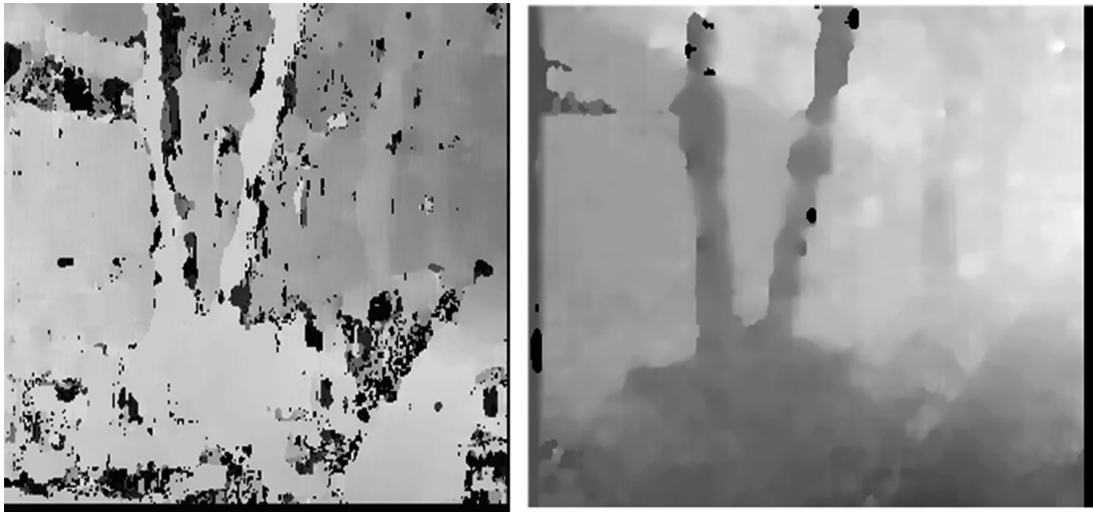
Figura 5. Resultados de la comparación de algoritmos. A la izquierda el algoritmo BM y a la derecha el algoritmo SGBM
