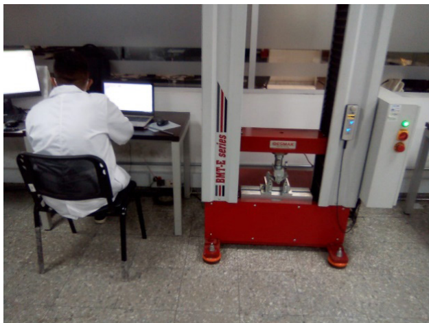
Foto 3. Máquina Universal De Tensión Y Compresión. Centro de Materiales y Ensayos del SENA
