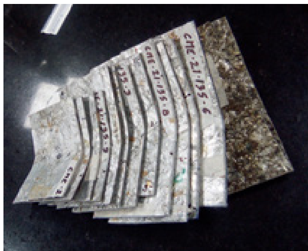
Foto 2. Probetas de polialuminio
