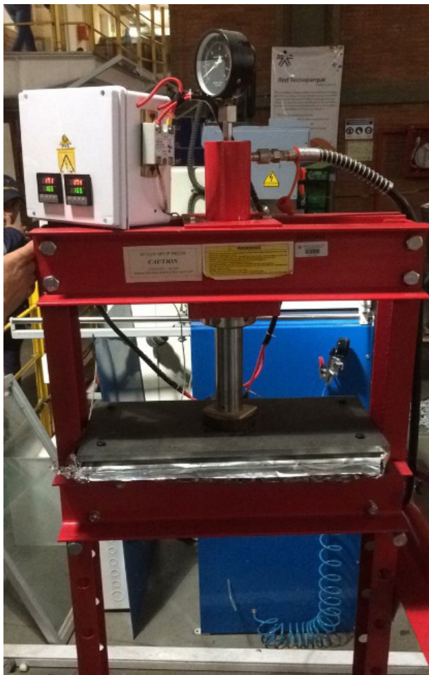
Foto 1. Termo Prensa Eléctrica Tecnoparque nodo Cazucá, SENA
